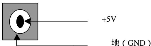
2. DAOUT1街头规格为 SMB-JWE 高频插头,接头是 ICETEK-VC5416-A 板的 DA 通道 1 的输出接口，接口输出 0 到 +5V 的电压。下面是接口的示意图：
