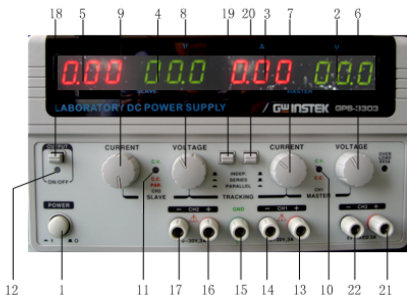
图 F4-1 GPS-3303C 型直流稳压电源面板图
